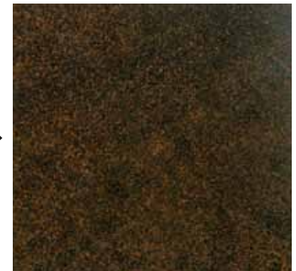
Cortenledning 12-18 mnd i friluft
