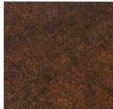
Cortenledning 4-6 mnd i friluft
